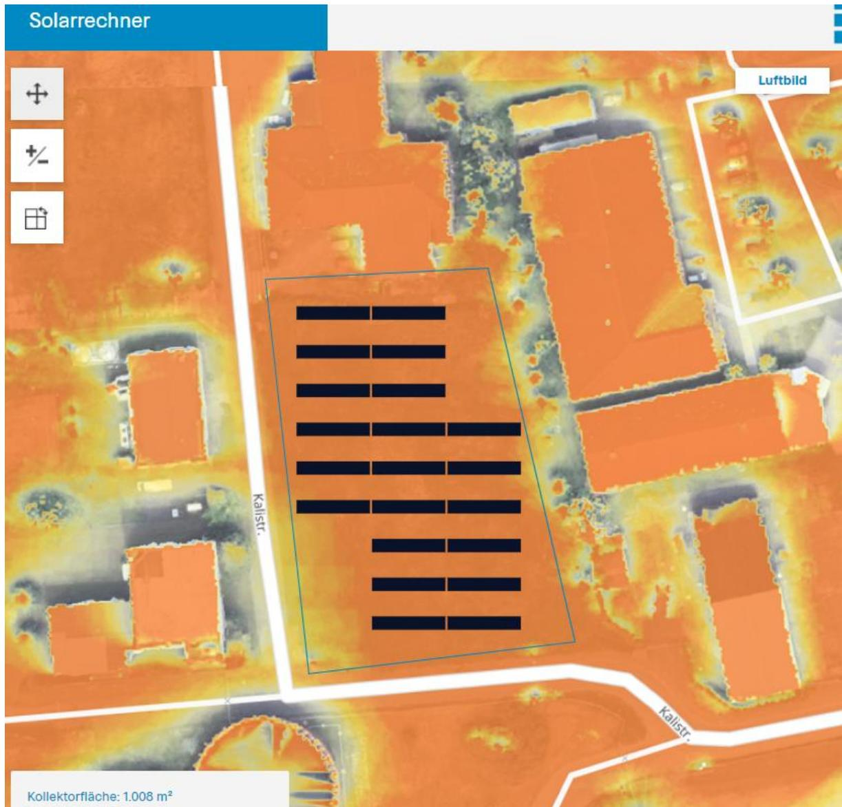
Abbildung 31: Screenshot Solarthermieanlage mit ca. 1.000 m<sup>2</sup> Bruttokollektorfläche
